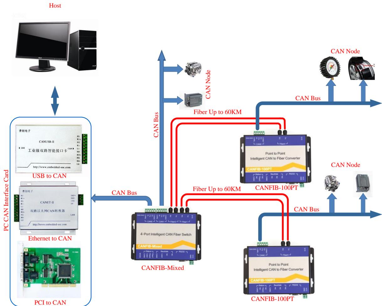
图 1-1-1 CANFIB-Mixed 智能CAN光纤交换机典型应用
