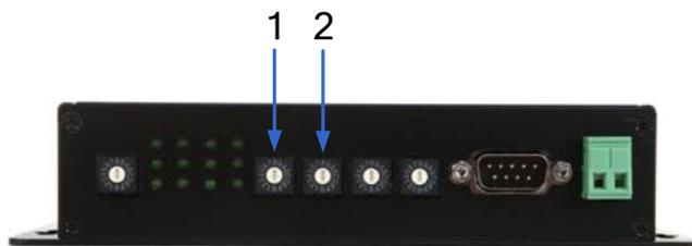
图 2-2-5-1 旋转拨码开关
