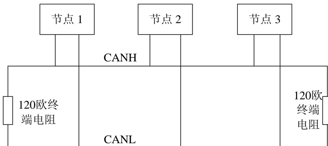
图 3-1-1 CAN-bus 网络的拓扑结构
